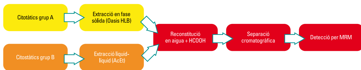
Figura 2. Esquema de processament de les mostres. El tractament preanalític (fase d'extracció) depèn del fàrmac a determinar, contingut en fàrmacs del grup A (l'extracció es fa per fase sòlida) o els fàrmacs del grup B (extracció líquid-líquid).
